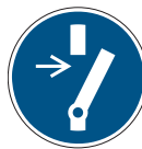
M021: Vor Arbeiten freischalten
