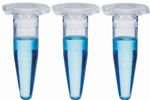
Tubos de microcentrífuga de polipropileno sin ADNasa ni ARNasa y apirógenos
